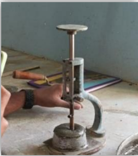
Fig. No. 4.7: Vicat Apparatus
