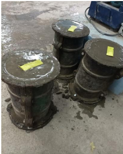
Fig. 6.7 Cylinder Specimens ( 150\text{mm} \times 300\text{mm} )
