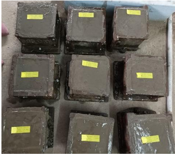
Fig 6.6 Cube Specimens ( 150\text{mm} \times 150\text{mm} \times 150\text{mm} )
